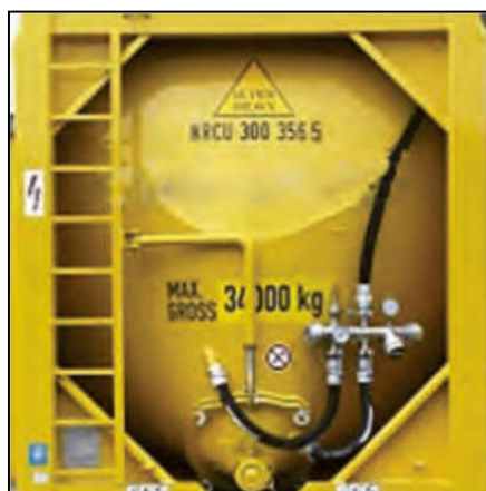
شکل ۹: شیرهای اهرمی و محفظه خروجی کانتینر
