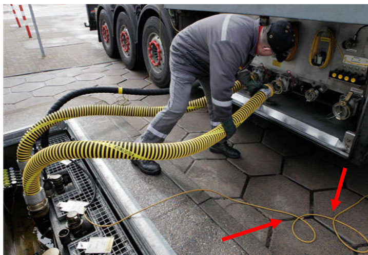
شکل ۱۲: اتصال سیم ارت در هنگام تخلیه و بارگیری فرآورده های نفتی
