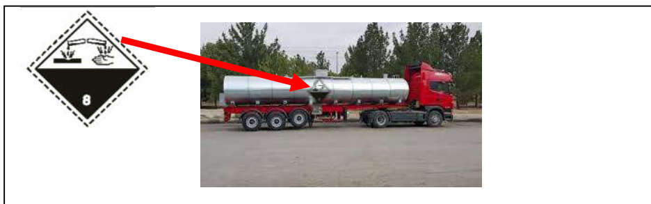
شکل ۶: تانکرهای استیل مخصوص حمل مواد خورنده
