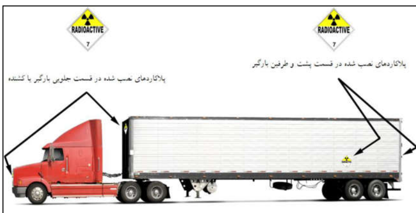
شکل ۱: نحوه نصب تابلوهای مواد خطرناک بر روی وسیله نقلیه
