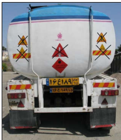
شکل ۳: استفاده نادرست از علائم
